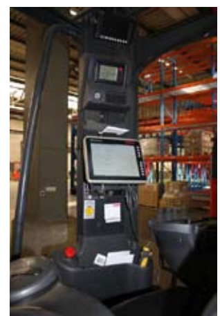
Kommissionierung ohne Papierlisten. Aufträge aus dem haus-eigenen Scope-System werden direkt auf den robusten Staplerterminals angezeigt.
