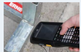
Artikelein- und ausgänge werden gescannt und mit Baustellen-Nr. und Lagerplatz erfasst.
